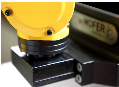
Intelligentes Roboter-Greifersystem für alle Paletten mit nur einem Greifer für alle Grössen (Systembreiten 100 bis 200 mm)
