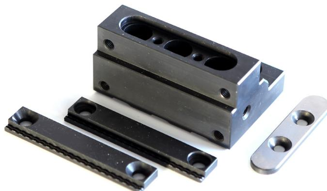
Zum umfangreichen Zubehör gehören diverse Aufsatzbacken und Krallenbacken in Höhen 3 und 5 mm. Die Aufsatzbacken können beidseitig mithilfe einer Verzahnung in 2 mm Schritten positioniert werden.
