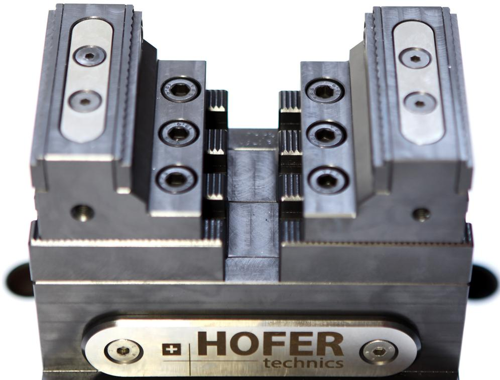
Die Konstruktion des Zentrisch-Spanners REX ermöglicht eine völlige Kapselung ohne zusätzliche Dichtlippen. Dadurch können die beiden Spannschlitten bis auf Distanz 0 zusammenfahren. Werkstücke können somit direkt in den Spannschlitten oder mit Aufsatzbacken gespannt werden.
