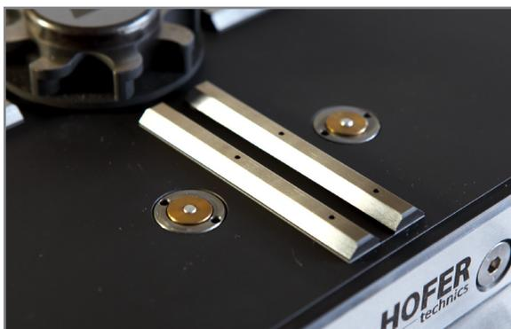
Aufnahmen in der Version V4 verfügen über 2 unabhängige Fluiddurchführungen. Diese werden automatisch an die Spanner ange dockt, und nach dem Einsatz wieder geschlossen und eingefahren.
