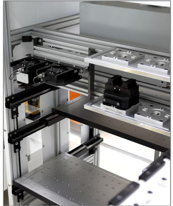
Ablagen für 4 pneumatische Zentrischspanner sowie bis zu 3 Robotergreifer (Abb. oben)
