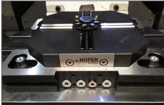
Die Aufnahme kann in der Version V2 entweder von unten durch den Maschinentisch, oder seitlich durch Anschlüsse angesteuert werden.
