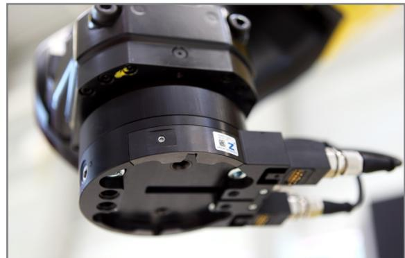
Greiferwechselsystem für verschiedene Greifer (Hybrid)
