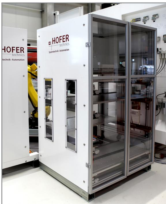
Optionale Schubladen mit Ablagen für bis zu 24 Paletten Systemgrösse 100. Benötigt wird dafür der HOFER Mini-Gripper und die M-Version (Abb. unten)
